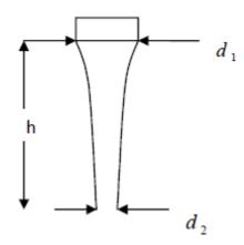
Т.н. «уравнение непрерывности»  $V_1S_1=V_2S_2$  связывает скорости и поперечные сечения струи на разных высотах. Перепишем его, введя диаметры струи, в виде:  $V_1{d_1}^2=V_2{d_2}^2$ . Уравнение Бернулли, являющееся, фактически, законом сохранения энергии позволяет связать скорости соотношением  $V_2{}^2-V_1{}^2=2gh$ . После элементарных математических
